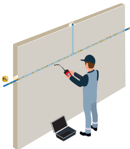
Detección de fugas mediante gas trazador en una tubería de agua
